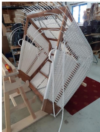
4. Het dak vlechten
